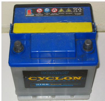
Figure 6.3 – Batterie automobile au plomb de 12V.
