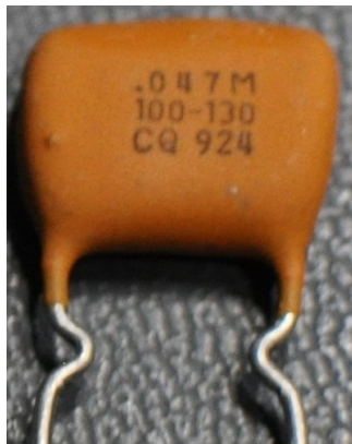
Figure 11.1 – Condensateur en céramique.
