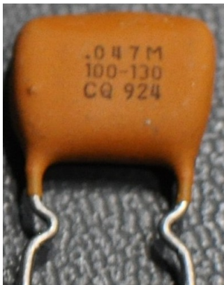
Figure 11.2 – Condensateur en céramique.
