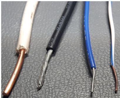
Figure 7.1 – Différents fils électriques.
