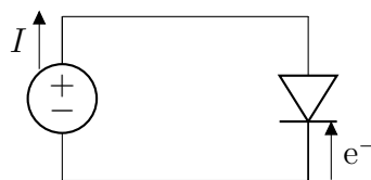
FIG. 2.4: Sens du courant conventionel vs des électrons
